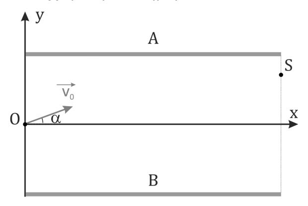
On constate que les protons sortent par le point S avec une vitesse horizontale.
